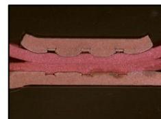
樹脂固めせずに縦断面のサンプルを作成することができます。専用のクランパーとカット刃を使用し 0.18sq~2sq のサイズに対応しています。
