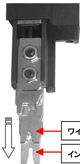
③: 新しいワイヤークリンパーとインシュレーションクリンパーを 取付けます。
