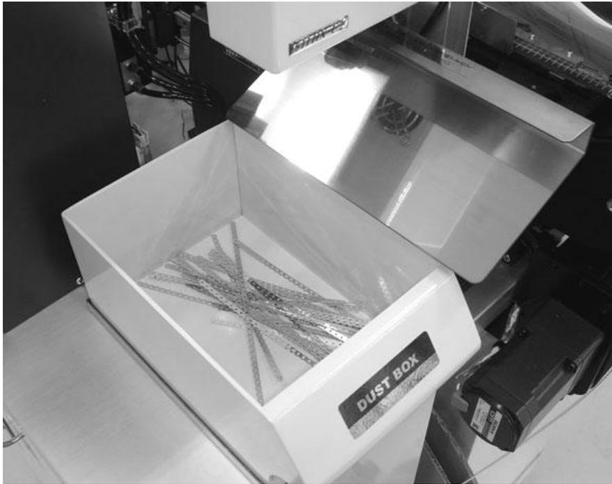
•端子送料带废料：从废料排出管道漏出来的长度达到约 120mm的时候，会自动切断。
