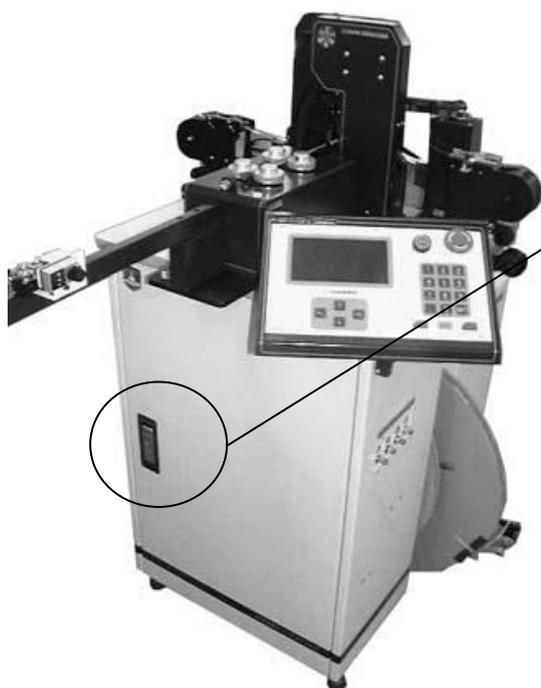
打开入口侧下方的门，就能看到主基板和 MDU 基板（参照照片）
