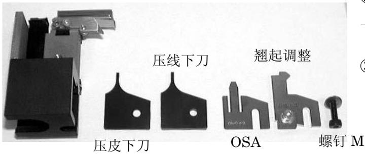
②以压皮下刀，压线下刀，OSA，翘起调整的顺序装上，用螺钉 M 临时固定好。
