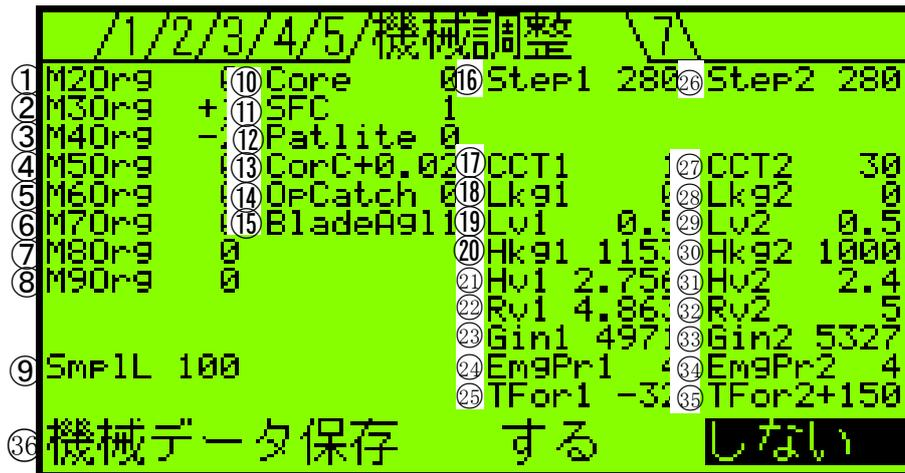
①《M2Origin》:导线管的原点   +:从刀片**远离**    -:向刀片靠近
