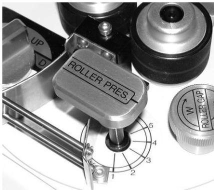
f. 3 口圧:ローラー圧力 加工する線材の種類により、線材を挟むローラーの圧力を調整しますが、その位置をこのメモに記憶させておき、メモリー読出したとき圧力つまみをこの数値に合わせます。
