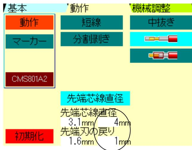
上の画面の場合、先端芯線直径は3.1mm、刃の戻りは1.6mmで、外被覆の直径は4mm、刃の戻りは1mmの設定となります。
