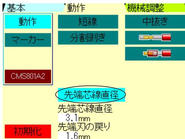
《先端芯線直径》を押すと画面に《先端芯線直径》《刃の戻り》が表示されます。それぞれ0.01mm単位で設定できます。
