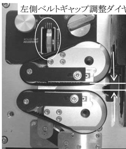
左側ベルトギャップ調整ダイヤル
