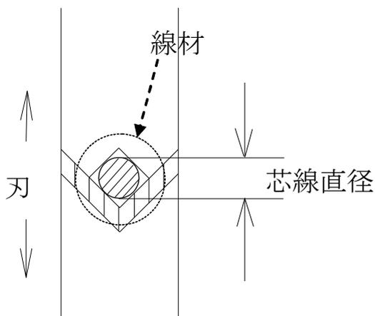
剥ぎ取り時の刃の深さは、加工を行う線材の芯線の直径を《芯線直径》に入力して下さい。
