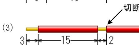
“後端 2mm”の分、被覆を動かし切断する
