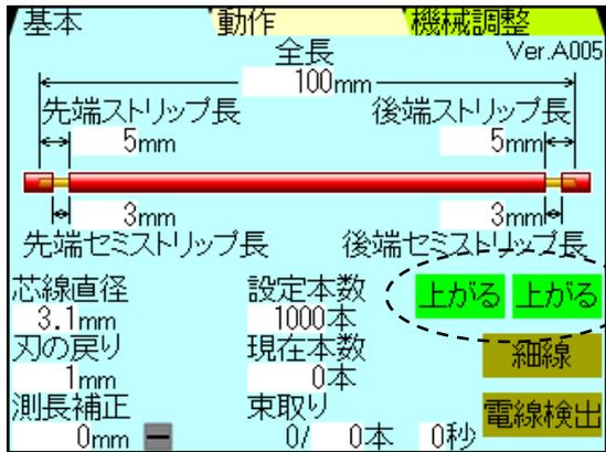
《ロールアップ1》《ロールアップ2》を選択しますと、基本画面に《上がる》キーが表示されます。
