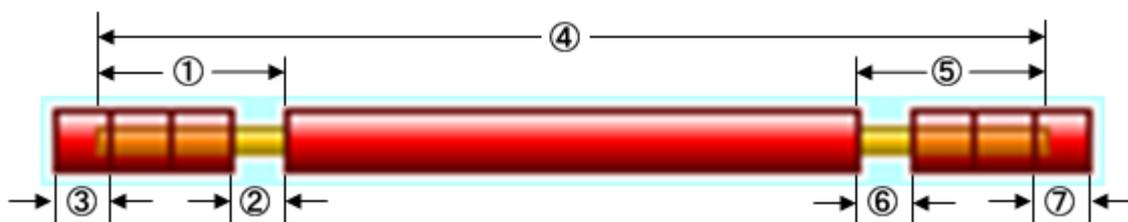
①《先端ストリップ長》:先端側被覆の剥ぎ取り長を設定します
