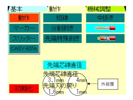
この画面の場合、先端芯線直径は $3.1 \, \text{mm}$ 、刃の戻りは $1.6 \, \text{mm}$  で、外被覆の直径は $4 \, \text{mm}$ 、刃の戻りは $1 \, \text{mm}$  の設定となります。
