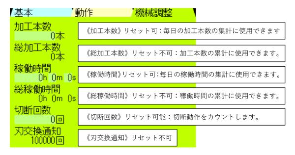
《刃交換通知》:上の《切断回数》が《刃交換通知》の設定回数を超えると、電源 ON 時・サイクル停止時・原点復帰時に「**刃を交換して下さい**」の表示が出ます。
