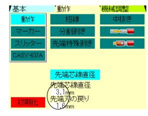
《先端芯線直径》を誤操作で有効に設定している場合、「先端のみストリップ出来ない」「先端の みストリップ位置で切断してしまう」といったトラブルが発生する場合があります。
