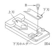
・ Bの M3 座付きキャップスクリューを付属の六角レンチで外 し、下刃から取り外します。
