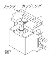
・ カッターブロックを取り付けます。カップリングの凹凸、ピン、 ノックピンとノック穴を本体側と正確に合せ取り付け、図3のAのM6キャップスクリューを締めて下さい。
