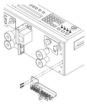
左図の様に付属 M4 座付きキャップスクリューにて CN-03 を固定して下さい。
