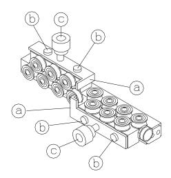
ウーローラー間の隙間を狭く(強く)し過ぎますと、測長時の抵抗になり加工した線材の全長寸法が 短くなります。
