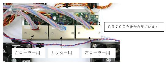
MDU 基板を本体から取り外す際は、MDU5860 基板の穴(2 カ所)奥の M3 キャップスクリューを緩めるだけで取り外せます。(下写真矢印の穴)
