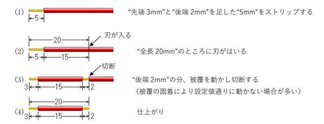
《分割剥き》のときの《基本》画面 《動作》画面(P.13の⑥)で《分割剥き》を選択します。 被覆と芯線との固着が強い・長いストリップなどでストリップが出来ない場合、分割してストリップを行います。
